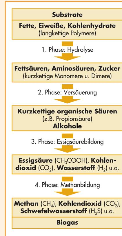
Abb. 10: Vereinfachte Darstellung des Abbaus organischer Substanz in der Biogasanlage
